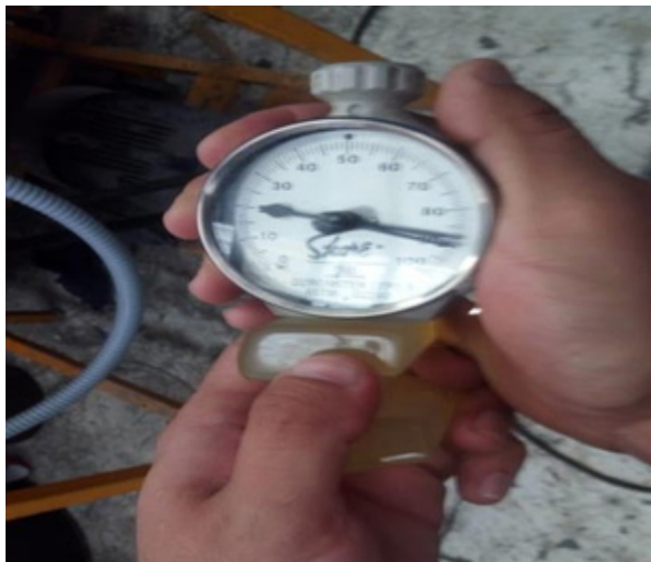
Figura 12. Medición de dureza
