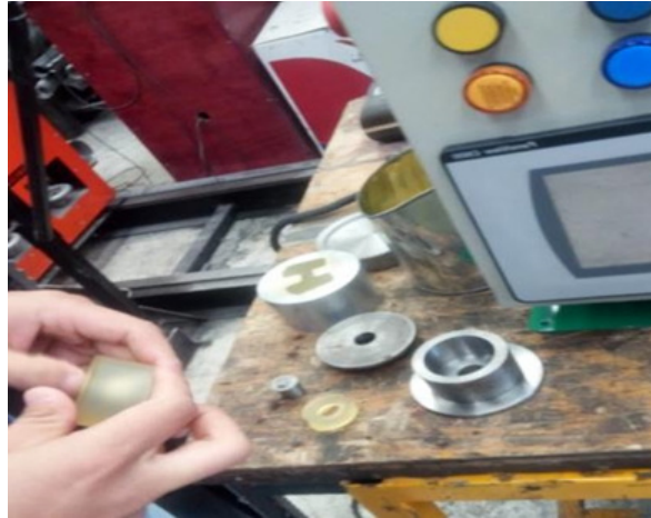
Figura 11. Desmolde de figuras de poliuretano
