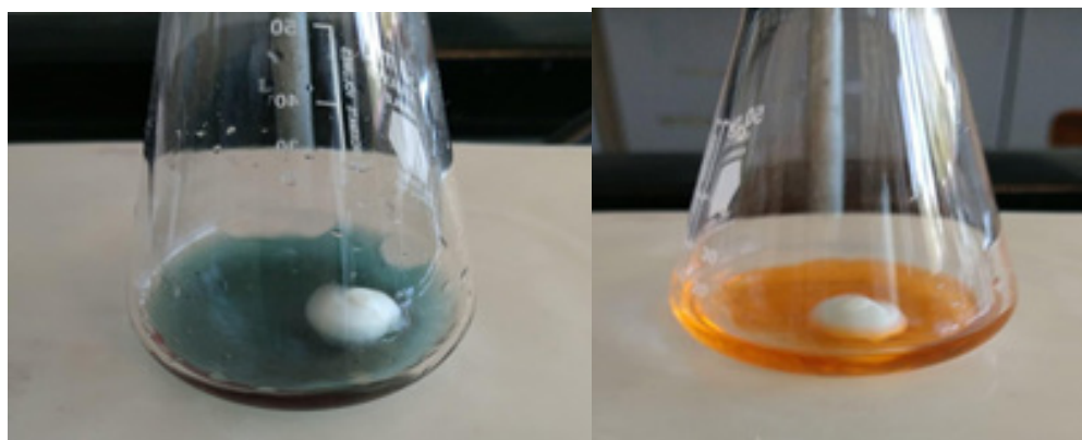
Figura 9. Valoración CROFERRON. Izquierda. muestra original, derecha. muestra fortificada con mercurio (20 ppm)
