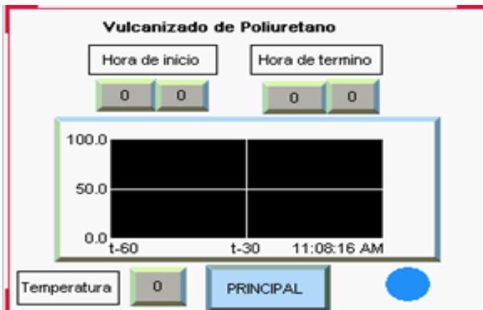
Figura 8. Pantalla de vulcanizado de poliuretano.
