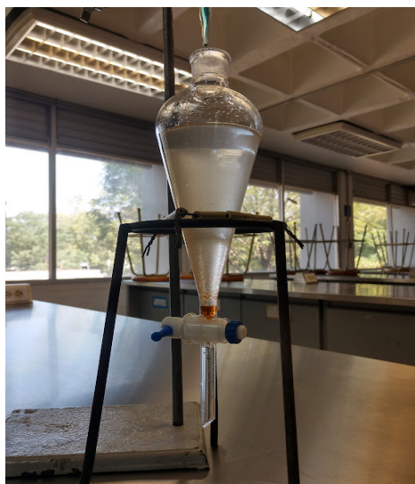
Figura 6. Metodología FEUM, método I: quelación (mercurio std 9.97 \times 10^{-5} M )
