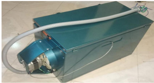
Figura 8. Horno implementado para el vulcanizado de poliuretano
