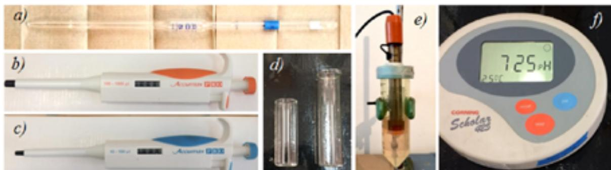
Figura 1. a) Pipeta volumétrica 5.0 mL b) Pipeta Accumax PRO (100-1000) L, c) Pipeta Accumax PRO (10-100) L, d) Celdas de vidrio e) Electrodo Corning® empleado y su recipiente contenedor. f) Potenciómetro Scholar 425®.
