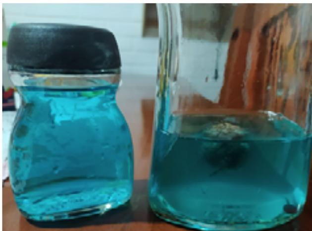
En la Figura 10 se muestra la solución sin catalizador A y con la esfera impregnada con 1% de concentración con el catalizador B, iluminada con luz artificial, en la cual se puede notar que en presencia de luz artificial no genera ningún efecto de degradación fotocatalítica.
