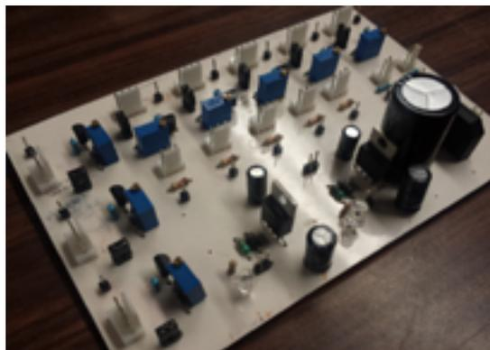
**Figura 14.** *Tarjeta de acondicionamiento de señales*
