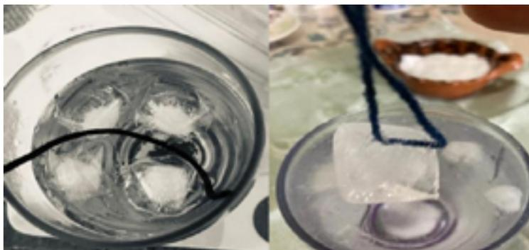
*Figura 1. (Izquierda) Estambre sobre superficie de un hielo. (Derecha) Al agregar sal común sobre la superficie del hielo y el estambre, disminuye la temperatura de fusión congelando el agua presente en el estambre lo cual permite "pescar el hielo."*
