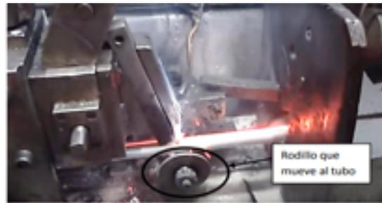
**Figura 1.** Rodillos guía y soldadura
